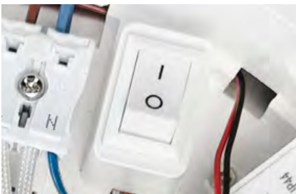
Per Schalter kann der indirekte Lichtanteil aus- oder dazugeschaltet werden.
